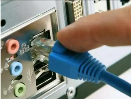
**Ordenador** de sobremesa conectado a red con cable RJ45
