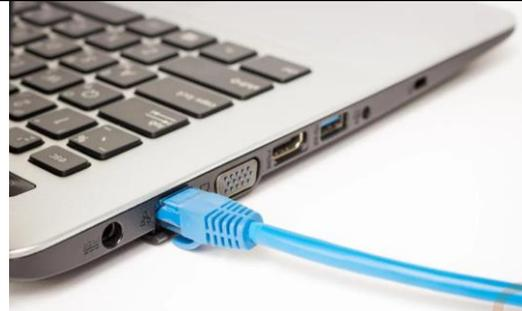
**Portátil** conectado a red con cable RJ45
