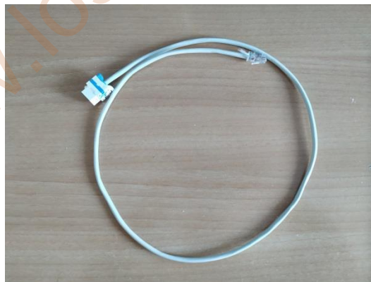
Cable conectado con la roseta y conector RJ 45 listo para ser usado
