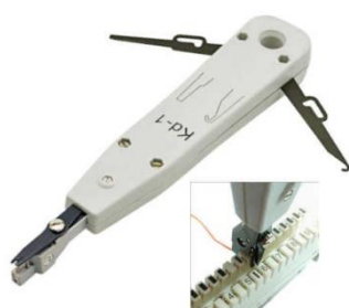
Crimpadora de impacto para cada una de las 8 conexiones del cable con el panel de parcheo.
