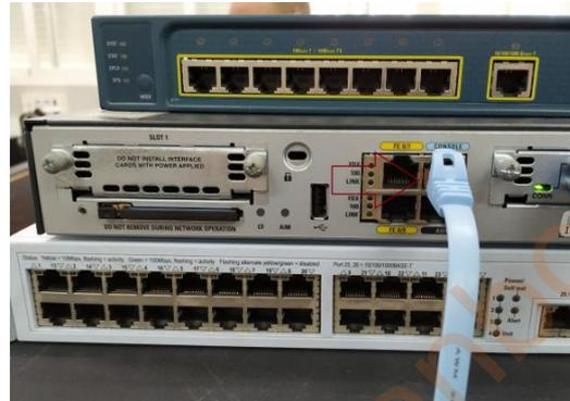
Conexión al puerto serie RJ45 del router
