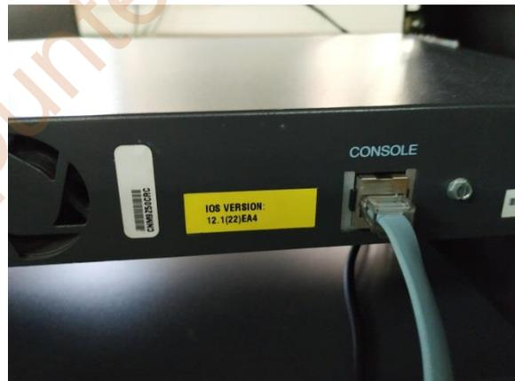
**Conexión al puerto serie RJ45 del switch conmutador.**
