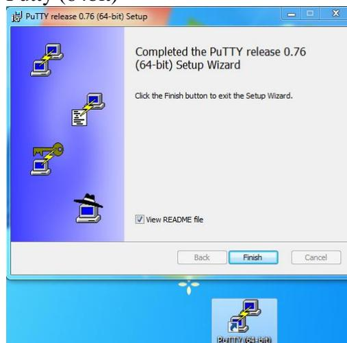
Clic en el acceso directo en el escritorio con el nombre de Putty (64bit) y se abre la siguiente pantalla que es la que utilizaremos para poder conectarnos con los dispositivos de Cisco. Para poder conectarnos con cable de consola serie RJ45 a DB9 tenemos que seleccionar en el menú de Putty configuración la conexión tipo “Serial” con COM1 a velocidad de 9600 baudios:
