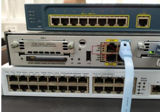
Conexión al puerto serie RJ45 del router
