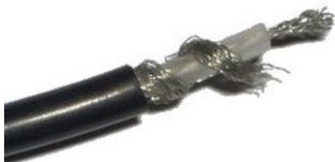
El cable coaxial es similar al cable utilizado en las antenas de televisión: un hilo de cobre en la parte central rodeado por una malla metálica y separados ambos elementos conductores por un cilindro de plástico, protegidos finalmente por una cubierta exterior.
