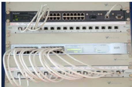
Para crear una LAN, necesitamos seleccionar los dispositivos adecuados para conectar el dispositivo final a la red (normalmente PCs). Los dos dispositivos más comúnmente utilizados son los hubs y los switches.
