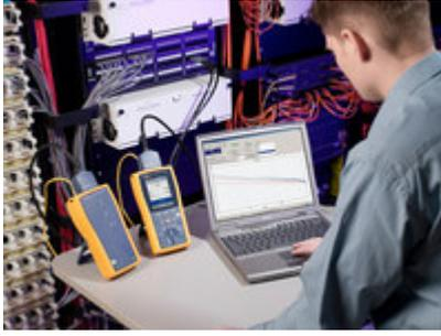
El correcto funcionamiento del sistema de cableado es tan importante que en muchas instalaciones se exige la certificación de cada uno de los cables, es decir, se compara la calidad de cada cable con unos patrones de referencia propuestos por un estándar. En el caso de los cables de cobre, la norma comúnmente utilizada es la ANSI/TIA/EIA-TSB-67 del año 1995, la norma EIA/TIA 568 y su equivalente norma ISO IS11801.
