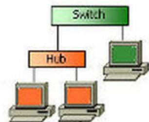
La función de un switch consiste en tomar la dirección **MAC** de una trama de datos y, en función de ella, enviar la información por el puerto correspondiente. En comparación con el hub, actúa más inteligentemente ya que filtra el tráfico y tiene capacidad de reconocimiento. Los datos pueden conducirse por rutas separadas, mientras que en el hub, las tramas son conducidas por todos los puertos.
