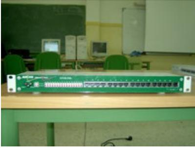
Un hub, también conocido como concentrador, es un dispositivo de red que actúa como punto de conexión central entre los nodos que componen una red. Los equipos conectados al propio hub son miembros de un mismo segmento de red, y comparten el ancho de banda del hub para sus comunicaciones.
