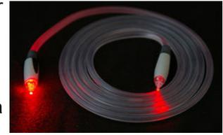
Al agregar una fuente de luz en un extremo de la fibra óptica y un detector en el otro extremo disponemos de un sistema de transmisión de datos unidireccional.
