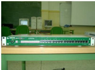
Un concentrador o hub es un dispositivo que permite centralizar el cableado de una red y poder ampliarla. Esto significa que dicho dispositivo recibe una señal y repite esta señal emitiéndola por sus diferentes puertos. Los equipos conectados al propio hub son miembros de un mismo segmento de red, y comparten el ancho de banda del hub para sus comunicaciones.
