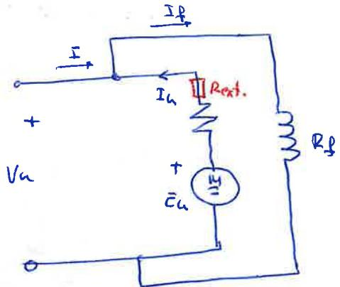
$$\text{Siempre } C_m \propto \phi I_a \Rightarrow C_m \propto I_a \text{ ya que } \phi = \text{cte}$$
