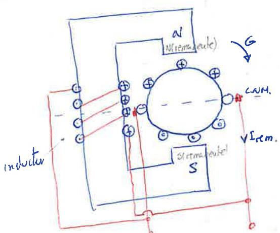
esquema de la máquina derivación.
