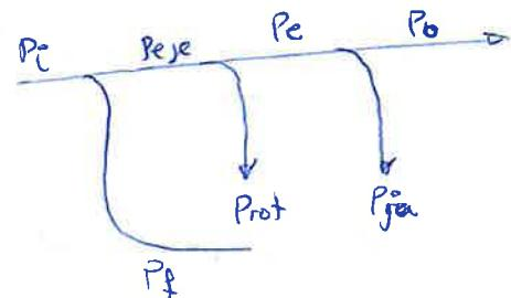
b) dinamo shunt o derivación. (paralelo)
