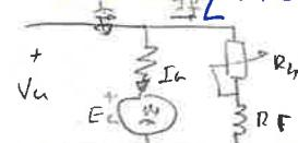
a) para  $R_h = 0\Omega$  resulta:  $I_f = \frac{V_u}{R_f} = \frac{240}{100} = 2'4A$ .  $I_a = I - I_f = 200 - 2'4 = 197'6A$
