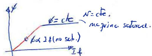
a)  $\phi = \text{cte} \Rightarrow$  es saturado  $\Rightarrow C_m \propto I_f / (C_m \propto I)$
