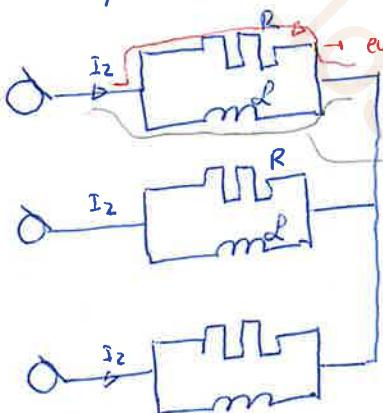
en el arranque la corriente circula por la resistencia para el arranque con un breve per.
