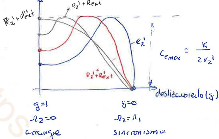
al arranque el motor va eliminando resistencia hasta quedar en la gráfica de  $R_2'$
