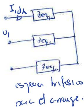
esquema trifásico para el arranque.
