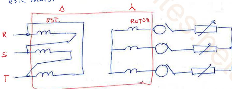
Rotor en marcha. (esquema por fase del rotor cuando está en marcha)
