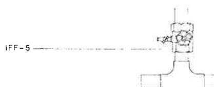
IFF-5 Llave de paso con grifo de vaciado roscada al tubo de acero previa preparación de éste con minio y estopa, pastas o cintas. Unión mediante racor al tubo de cobre.
