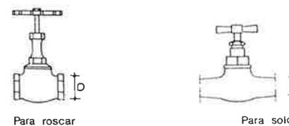
Permitirá el corte y regulación del paso de agua. De bronce o latón. Espesor mínimo 2 mm. Para roscar o soldar. Estanca a la presión de 15 atm. Diámetro -D en mm.
